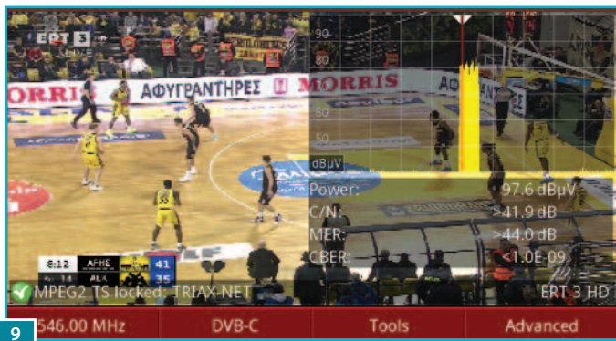
9 Λήψη επίγειου ψηφιακού καναλιού από QAM συχνότητα εξόδου (DVB-C) του Headend.
