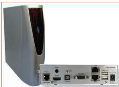
10 Ο S-Box είναι ένα πολύ καλό μηχανήμα, που λαμβάνει σήμα από τη θύρα Ethernet και έχει εξόδους για σύνδεση με την τηλεόραση.
