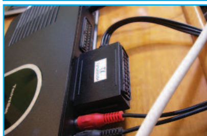
2 Ο αντάπτορας Jack σε Scart του πομπού έχει και έξοδο Scart.
