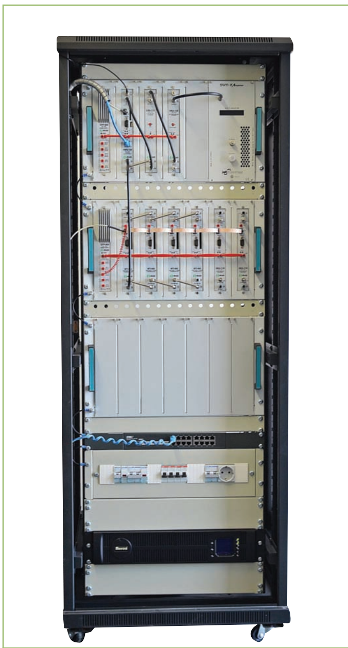
7 Μια συνολική λύση με 4 δορυφορικά & 2 επίγεια streams, UPS, τηλεδιαχείριση, αντικραδική προστασία κ.ά. σε rack 19" 32U.
