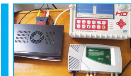
1 Το MAC Home δέχεται το σήμα από το δορυφορικό δέκτη και αποδίδει το ψηφιακό κανάλι που φαίνεται στο πεδίομετρο.
