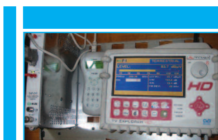
2 Υψηλή στάθμη εξόδου της τάξης των 83dBmV και άριστο C/N από τον διαμορφωτή μονής πλευρικής.
