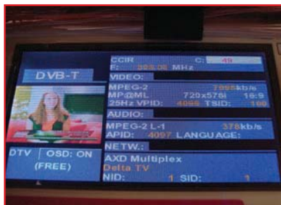
1 Στο πρώτο κανάλι του πακέτου, το περιφερειακό Δέλτα TV, δώσαμε bitrate 8000Mbps
