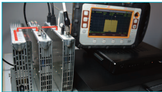
2 Δοκιμή του διαμορφωτή με τον δέκτη της NOVA και ένα DVR ως πηγές HD.
