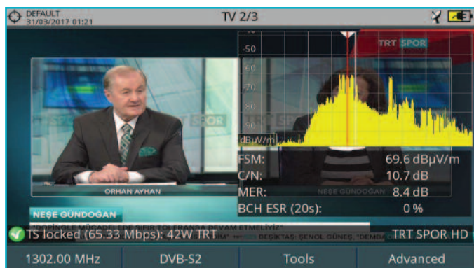
1 Εικόνα δορυφορικού καναλιού και ανάλυση φάσματος με τιμές σήματος C/N, MER.
